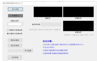
编码器配置一个RS485接口，用户可以利用此接口和PC通信，修改数据方向，也可以读取编码器数据。设置软件需到本公司网站下载[www.lan-man.com](http://www.lan-man.com)。
